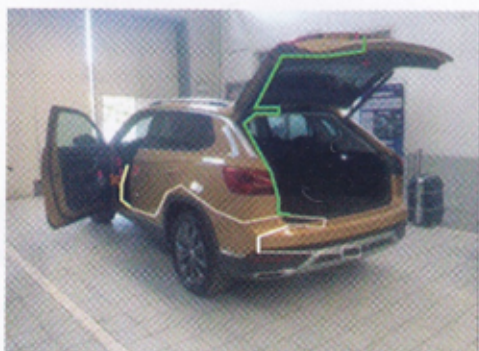
3. 1 je kladný kábel dveri kufru, to je kábel spínača. A 2 je permanentný 12V kábel. 3 je kábel ACC (zapaľovací). 4 je GND (zem)
