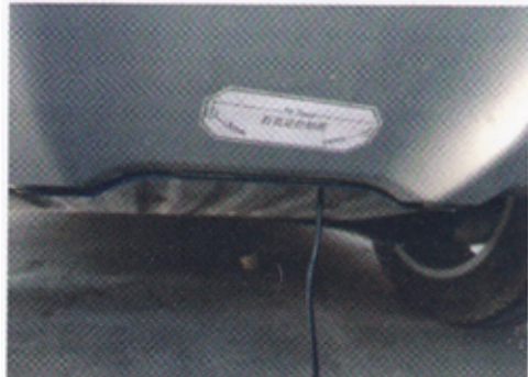
5. Umiestnite montážnu nálepku na nárazník a vyrazte dva otvory na označenie, aby sa skrutky ľahšie utiahli.
