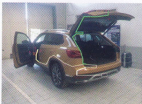
3. Ușa portbagajului 1 cablu pozitiv, adică cablul comutatorului. Iar 2 este cablul permanent de 12V. Cablu ACC 3 (aprindere). 4 este GND (masă)
