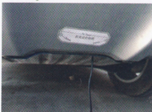
5. Așezați autocolanțul de montare pe bara de protecție și perforați două găuri de marcare pentru a înșuruba mai ușor șuruburile.
