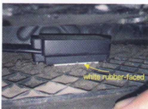
7. Localizați șuruburile strânse din interiorul barei de protecție și instalați senzorul cu adezivul 3M în jos.
