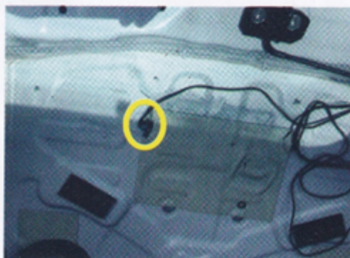
4. Ascundeți cablul de comunicație prin portbagajul, plasați senzorul într-o poziție fixă și fixați-l.
