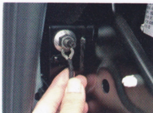
1. Conectați-vă la GND (Pământ)
